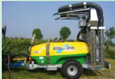
Atomizzatore carrellato, telaio zincato a caldo, bifilare e trifilare della capacità di 2000 lt.
